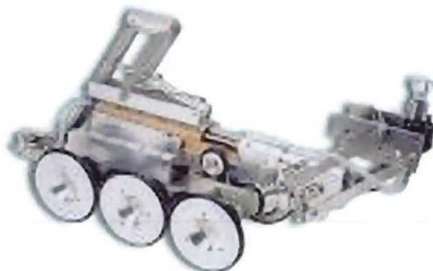
Figura 13 - Robô do tipo ROV (Remotely Operated Vehicle) usado no reparo de tubulações.
