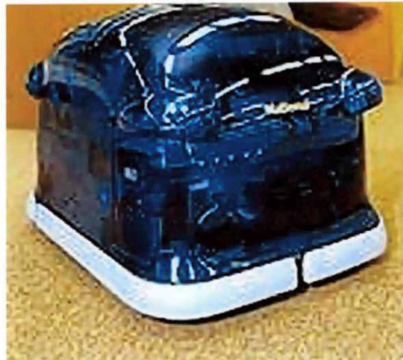
Figura 8 - Robô aspirador de pó da Matsushita da sua linha doméstica.
