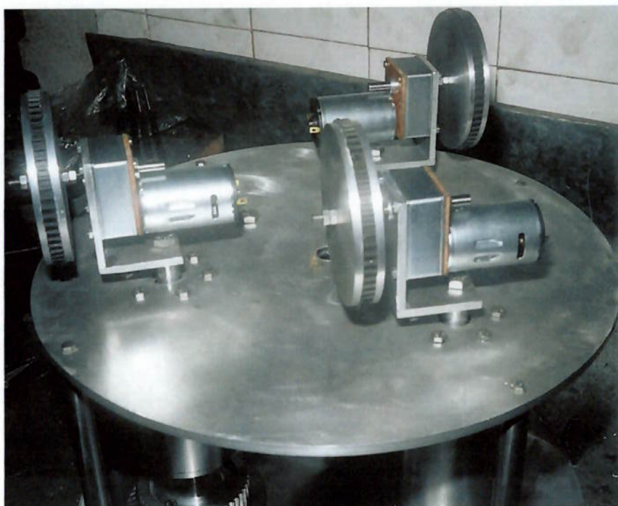
Figura 28 - Montagem dos suportes dos motores com as suas respectivas rodas.
