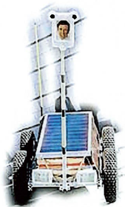
Figura 10 - Afghan Explorer robô desenvolvido no MIT dotado de laptop e câmeras de vídeo para ser controlado por um repórter em locais hostis como campos de guerra.
