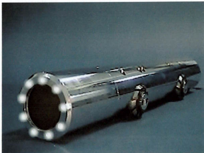
Figura 12 - Um segundo tipo de robô do tipo ROV (Remotely Operated Vehicle) utilizado na inspeção de tubulações de esgoto de pequeno diâmetro em uma versão monobloco, com câmera fixa.
