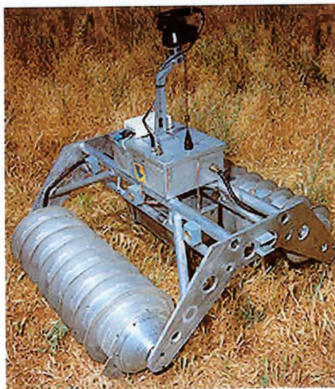
Figura 6 - Outro tipo de robô terrestre utilizado na detecção de minas terrestres e que se desloca através de dois fusos.
