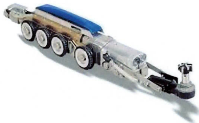
Figura 14 - Um segundo tipo de robô ROV (Remotely Operated Vehicle) usado no reparo de tubulações.
